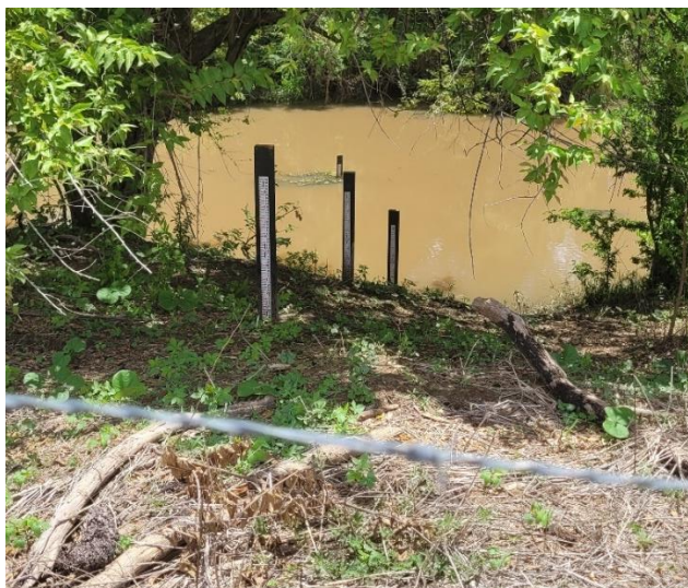
Figura 02 – Seção de réguas linimétricas no rio Cruxati, afluente ao aç. Orós (Iguatu).
