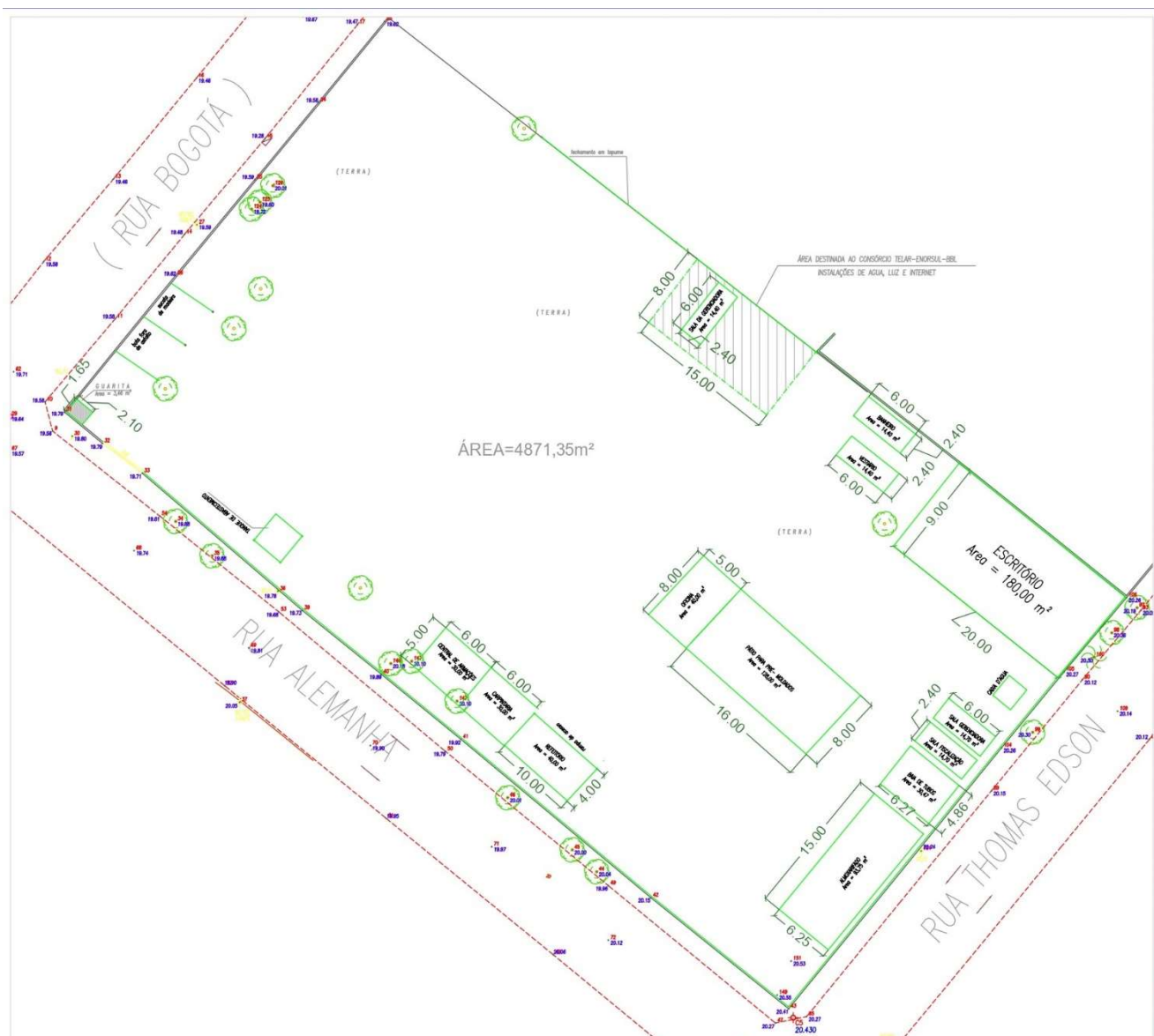
Figura 3 - Croqui do canteiro de obras
