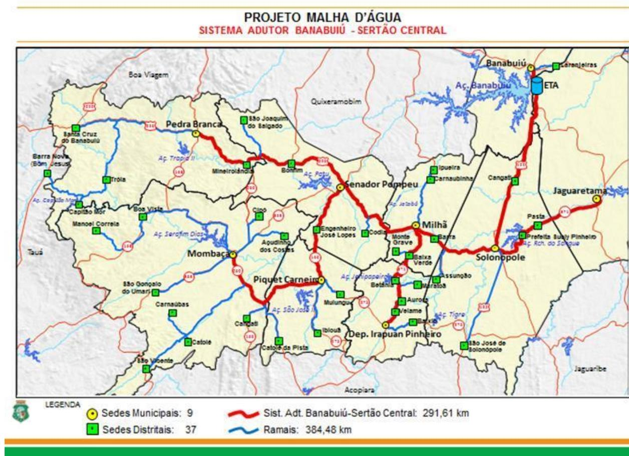
O sistema adutor deverá ser constituído por captação de água bruta na bacia hidráulica do reservatório Banabuiú; estação de tratamento de água próxima à captação; estações elevatórias sendo uma de água bruta na captação e as demais, de água tratada, ao longo das linhas de adução, e tubulações adutoras até os sistemas de distribuição existentes nos núcleos urbanos beneficiados.
