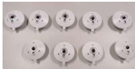
Sensor de radiação solar CMP6 (1 unidade, esquerda; 9 unidades, direita).
