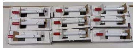
Sensor de temperatura e umidade relativa do ar (1 unidade, esquerda; 9 unidades, direita).
