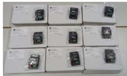
Sensor de pressão barométrica (1 unidade, esquerda; 9 unidades, direita).
