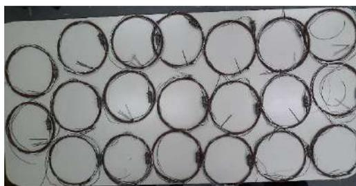
Sensores de temperatura do solo modelo TCAV-L34
