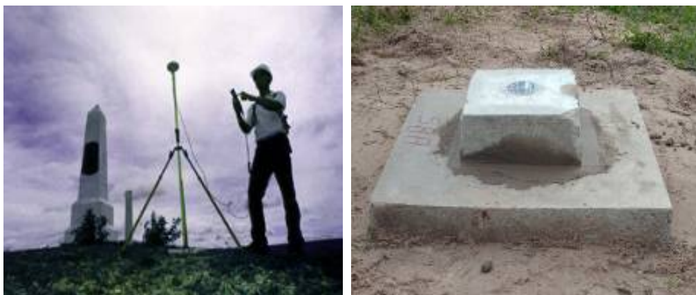
Figura 04: Exemplo de vértice de apoio básico com coleta de coordenadas GPS.
